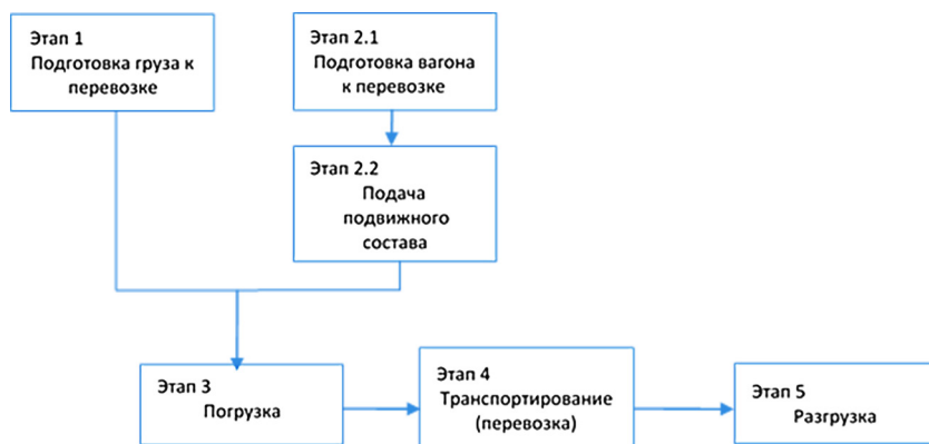
Рис. 2. Схема перевозочного процесса
